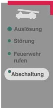
Die LED **Auslösung** (6) blinkt (grün oder gelb), wenn die Übertragungseinrichtung aktiviert ist, d.h. dass die Feuerwehr bereits gerufen ist.
