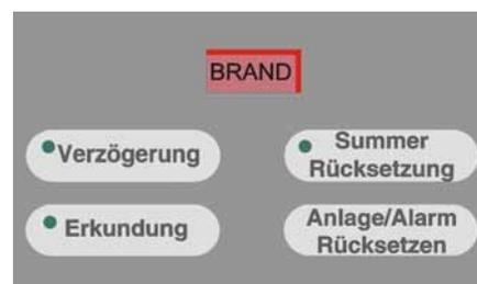
Durch Drücken der Taste **Verzögerung** (2) kann die Weiterleitung eines Brandalarms um eine bestimmte Zeitspanne verzögert werden (z.B. um die Auswirkungen von Täuschungsalarmen zu reduzieren).
