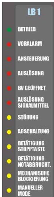
Die grüne LED **Betrieb** leuchtet, wenn kein dem Löschbereich zuordenbares Element gestört oder abgeschaltet ist und die Notabbruchtaste nicht aktiv ist.
