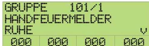
Nachdem ein Element ausgewählt wurde, kann sein Zustand mit einer der Tasten **Ein** (29), **Ab** (30), **Setzen Rücksetzen** (31) oder **Weitere Befehle** (32) verändert werden.
