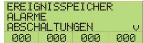
Nach Betätigen der Enter-Taste gelangt man in eine weitere Liste, in der alle verfügbaren Ausdruckarten aufgelistet sind (vollständiger Ereignisspeicher oder mit Meldungsfilter für Alarmer, Abschaltungen, Auslösungen etc.). Nach Auswahl der Ausdruckart und Betätigen der Enter-Taste erfolgt der Ausdruck auf dem gewählten Drucker.
