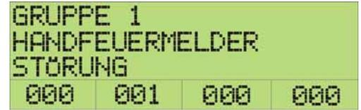
Befindet sich die Brandmelderzentrale gleichzeitig in Alarmzustand, wird auf dem Display die Alarmliste angezeigt, die Störungsliste kann mit der Taste **Störungen** (22) aufgerufen werden.
